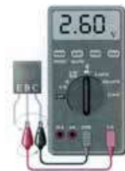
شکل ۱۲-۴۹ ترانزیستور معیوب (قطع)
