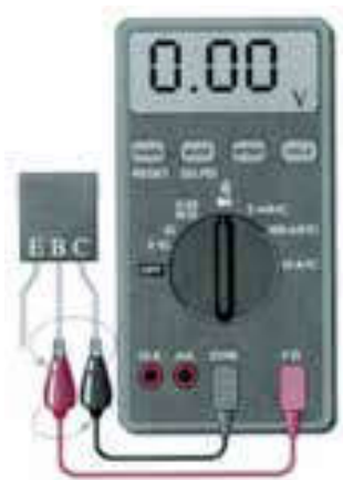
شکل ۱۲-۵۰ ترانزیستور معیوب (اتصال کوتاه)
