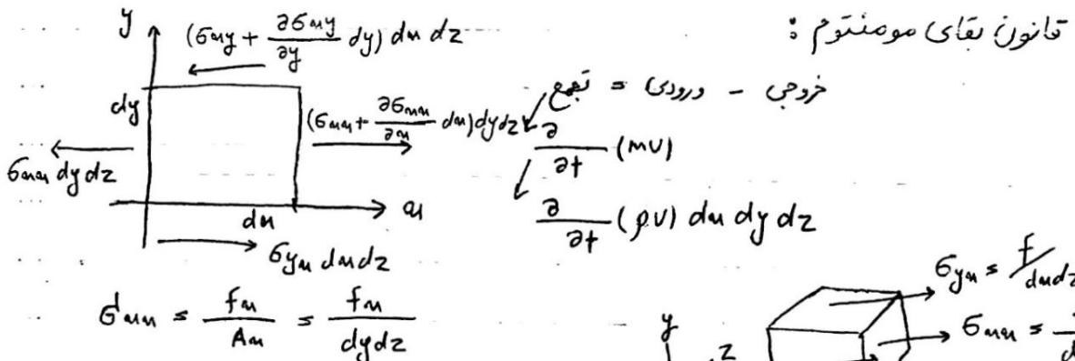
$$f_{uu} = G_{uu} dy dz + G_{uu} du dz + G_{uu} du dy$$
